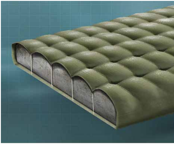
चित्र-1. आर्टिकुलेटिंग ग्राउटेड कंक्रीट मैट्रेस के आकार का क्रॉस सेक्शन व्यवस्था
